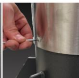
Camicia sostituibile in acciaio inox
